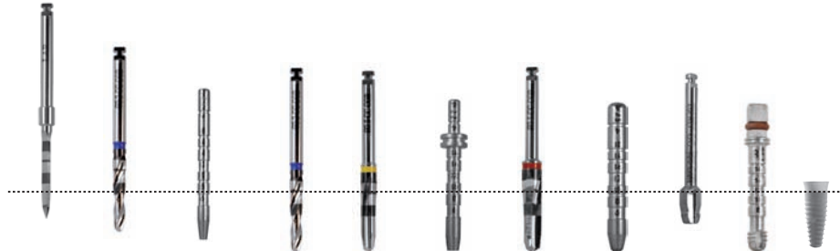
Fresa lanza Fresa helicoidal Ø 2.2mm Medidor de profundidad Ø 2.2mm Fresa helicoidal Ø 2.2mm Fresa helicoidal Ø 2.8mm Medidor de profundidad Ø 2.8mm Fresa helicoidal Ø 3.5mm Medidor de profundidad Ø 3.5mm Fresa de perfil Ø 4.1mm Macho de rosca Ø 4.1mm
